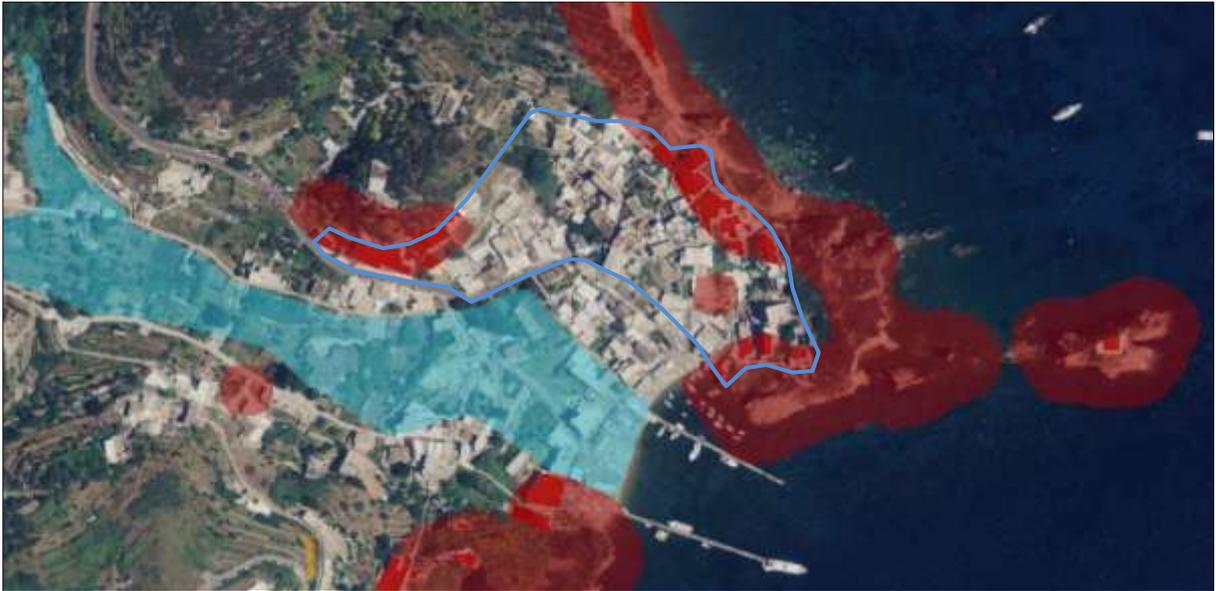
Fig. 6 – Portale Cartografico Nazionale. Individuazione delle aree a pericolosità di frana molto elevata (rosso scuro) e rischio molto elevato (rosso acceso), e di attenzione idraulica in celeste, del Piano stralcio per l'Assetto Idrogeologico.
